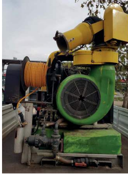
Şekil 7. Bir mist blower cihazının genel görünümü
