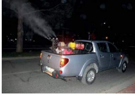
Şekil 6. Akşam saatlerinde araç üstündeki bir ULV cihazı ile sisleme çalışması yapılması
