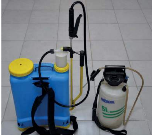
Şekil 3. Sırtta ve omuzda taşınabilen pulverizatör örnekleri
