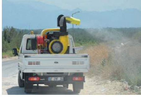
Şekil 8. Bir mist blower cihazının açık alanda biyosidal ürün uygulaması
